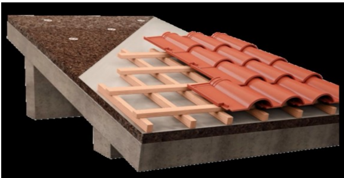
Скатная кровля без ветрозащиты
